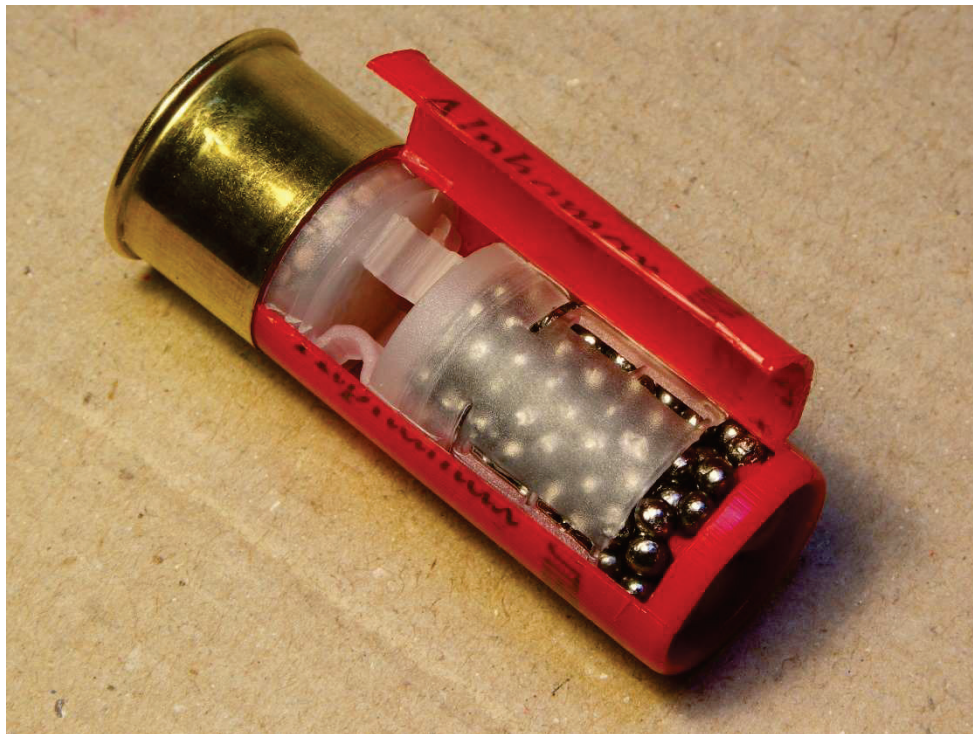
Figure 10 : Image de cartouche à grenaille, composée de billes de plomb (Crédit : Jean-Claude Tolphin)
